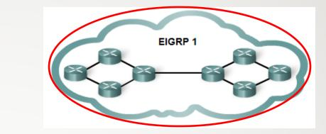
Router(config) # router eigrp autonomous-system
